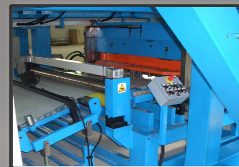
Dettaglio cesoia volante inferiore di intestatura
