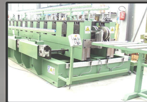
Dettaglio zona rulliera in uscita
