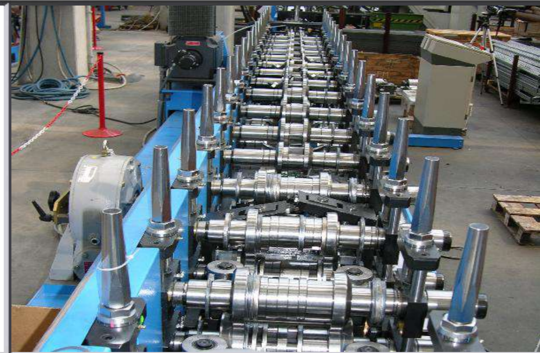
Profilatura profilo fotovoltaico
